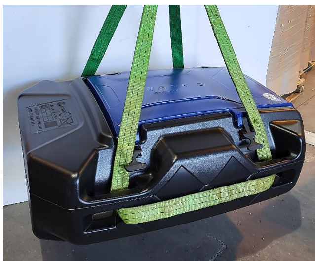
Kuva 5. IBC-pakkauksen nosto täytenä.
