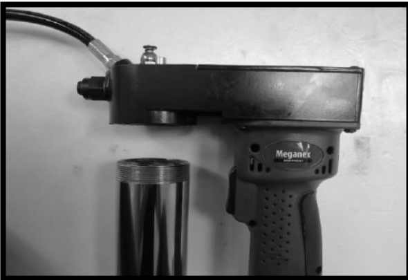
Kierrä rasvapatkua vastapäivään poistaessa. Kierrä myötäpäivään kiristettäessä.
