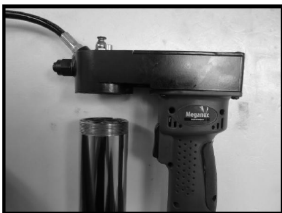
Vrid behållaren moturs för att demontera den. Vrid medurs för att dra fast.
