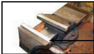
Ett mjukt skruvstycke (aluminium- eller kopparkäftar)
