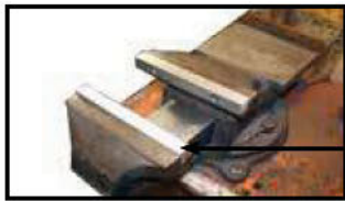
Ruuvipenkki/ruuvipuristin (alumiini- tai kuparileuat)
