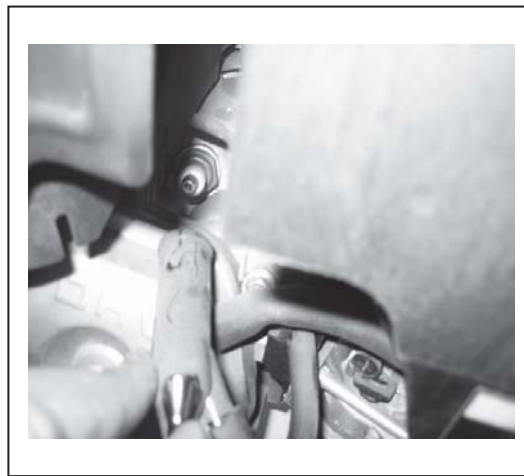
Irrota sytytystulpan johto.
