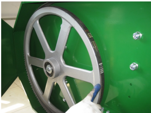
( Drivhulets högra sida är nära skyddet)
